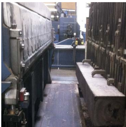
Zvětralé trámy jsou krájeny na tenkou dýhu.
